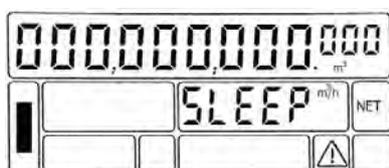
Schlafmodus: Je nach Einstellung des Zählers, spätestens jedoch nach 24 Stunden ohne Wassermessung, wechselt die Anzeige des Octave Ultraschallzählers in den Schlafmodus.
