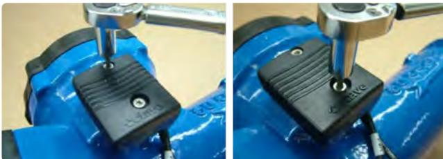
9. Setzen Sie den Dichtungsdeckel auf die Schraube.
