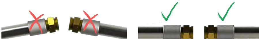
4. Bitte verwenden Sie für die Verlängerung ausschließlich Gummidichtungen und keine Glasfaserdichtungen. Nach Einsetzen der Dichtungen sollte die Lücke zwischen dem Endanschluss und dem Messgerät 1 mm nicht überschreiten.
