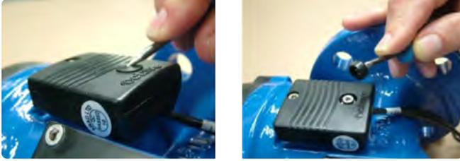
2. Heben Sie den Dichtungsdeckel mit Hilfe eines scharfen Werkzeugs von der Schraube.
