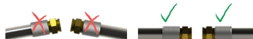
4. Ao utilizar a peça traseira padrão, utilize apenas juntas de borracha (não de fibra de vidro)! Depois de adicionar as juntas, a distância entre a ligação final e o medidor não deve exceder 1 mm.
