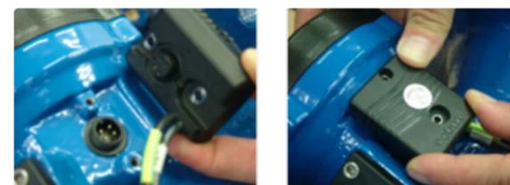
8. Aperte os dois parafusos apenas com a mão, utilizando uma chave Allen de 3 mm para obter uma pressão simétrica do anel de vedação e, em seguida, aplique o torque de 2 N\*m com uma chave dinamométrica
