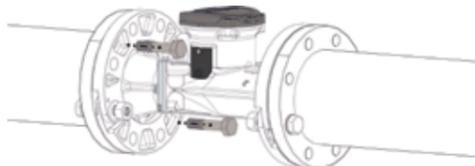
**6.2.** Aperte gradualmente os dois parafusos para aumentar o espaço entre a flange do medidor de água e a flange do tubo.
