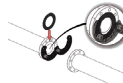
5. Se não for possível utilizar ligações de plástico num dos lados do medidor, considere a utilização dos acoplamentos flexíveis. Esses acoplamentos foram desenvolvidos especialmente para os medidores poliméricos Octave. Este acoplamento deve ser utilizado apenas num dos lados do medidor – instale o acoplamento na saída, se possível – tal como descrito nas imagens abaixo.
