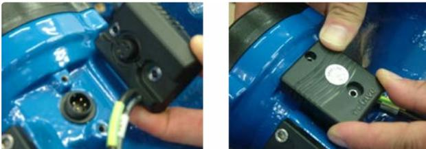
8. Ziehen Sie beide Schrauben mit Hilfe des 3 mm Innensechskantschlüssels per Hand fest, so dass symmetrischer Druck auf den O-Ring ausgeübt wird.
